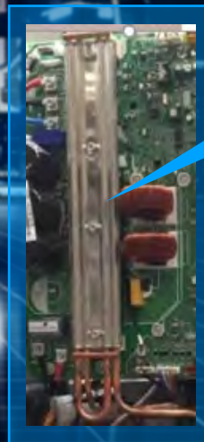
Охолодження холодоагенту РСВ
