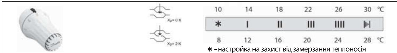
Встановлення необхідної температури повітря в приміщенні здійснюють поворотом рукоятки термостатичного елемента з нанесеною на неї шкалою настройки. На малюнку показано взаємозв'язок між позначками на шкалі настройки і температурою в приміщенні.
