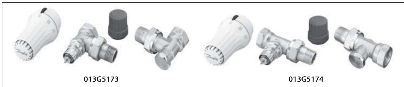
Комплекти, до складу яких входять терmostатичний елемент RAE і прямі або кутові клапани RA-N і RLV-S, застосовують для обв'язки радіаторів з бічним підключенням в двотрубних системах водяного опалення індивідуальних квартир, котеджів, невеликих комерційних будівель тощо.
