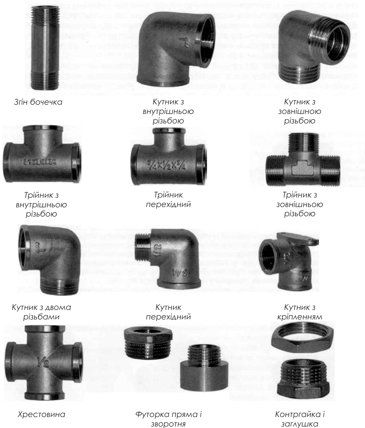
Рис.29. Фітинги для з'єднання сталевих труб
