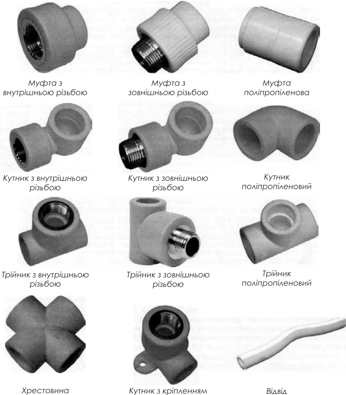
Рис.44. Різновиди фітінгів для поліпропіленових труб
