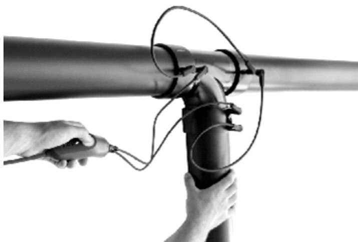
Рис.76. Електричне зварювання за допомогою трубних муфт
