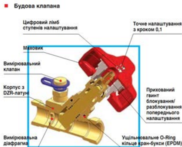
Рис.116. Будова ручного балансувального клапана.
