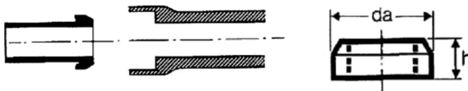
Рис.81. Перехід від чавунних до керамічних труб
