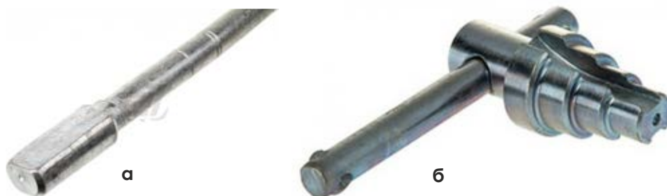
Рис.8. Ключі радіаторний (а) та для американок (б)
